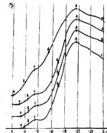
Мал.1. К-краї поглинання Fe в цементиті кремнієвої сталі, відпущеної при температурі 450 °С протягом 10 хвилин (1), 2-х годин (2), 6-ти годин (3) і вуглецевої нелегованої сталі (У10), відпущеної при температурі 450 °С протягом 10 хвилин (4).
